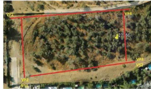
Figura N°17: Ubicación perfiles MASW y Tomografía.
