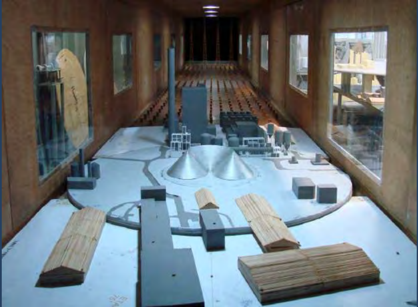
Celulose Riograndense, Guaíba, RS - Modelo da pilha de cavacos no interior do Túnel de Vento. Ângulo 266^{\circ} - Config. II / Posic. 225^{\circ}
