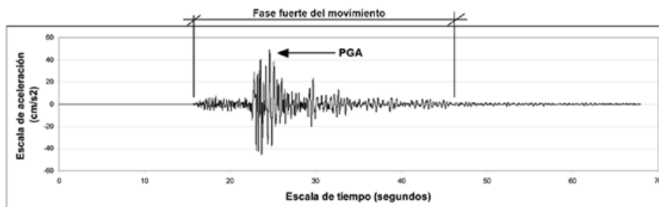
Figura 9. Componentes principales de un acelerograma. Fuente: Schmidt & Quirós, 2007.
